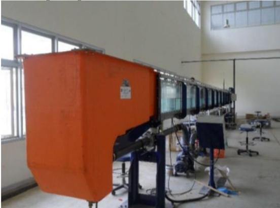
**Gambar 2. Saluran pembangkit gelombang (Armfield S6 MKII tilting flume)**
