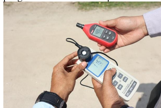
Gambar 5. Pengukuran intensitas radiasi matahari dan kondisi lingkungan pada saat pengoperasian Smart Solar Dryer Dome Hybrid
