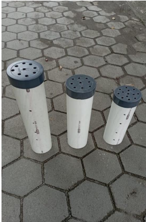
Gambar 3. Biopori dari pralon diameter 10 cm, panjang bervariasi yaitu 40 cm, 50 cm, 60 cm.
