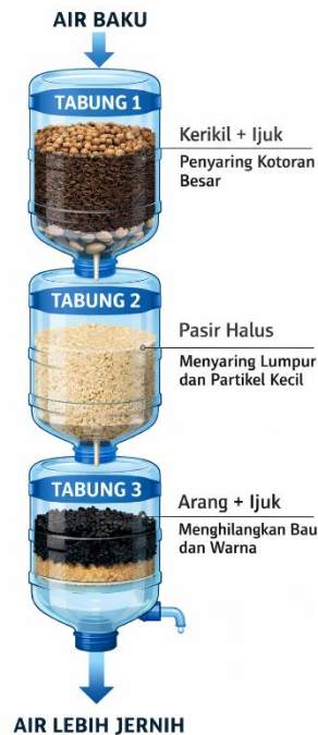
Gambar 4: Desain Alat Penyaring Air
