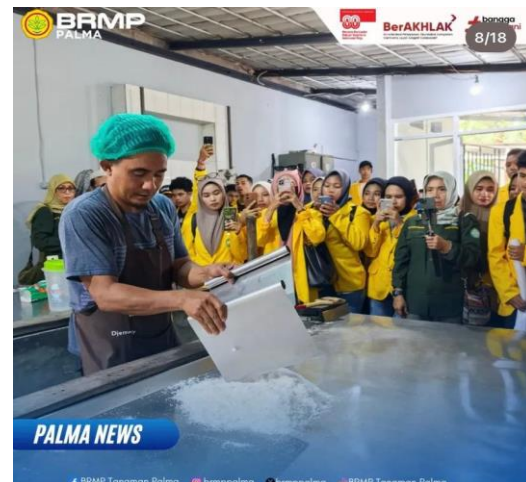
Gambar 1: Proses pembuatan Virgin Coconut Oil (VCO) dari daging kelapa melalui metode Direct Micro Expelling (DME) - (Dok. BRMP Palma)
