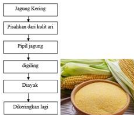
Gambar 3. Prosedur Pembuatan Tepung Jagung
