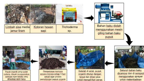
Gambar 1. Prosedur pembuatan pupuk organik dan pestisida dari limbah sisa media jamur tiram, kotoran hewan, dan Trichoderma sp.
