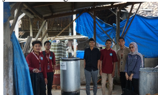
Gambar 5. Alat pirolisis untuk pembuatan asap cair dan arang bambu
