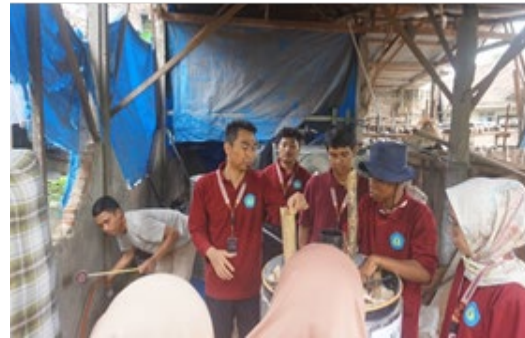
Gambar 4. Proses pembuatan asap cair dengan menggunakan alat pirolisis
