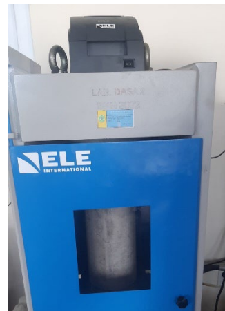
Gambar 11 : Pengujian kuat tekan beton
