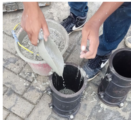
Gambar 7 : Proses Pencetakan Beton Uji
