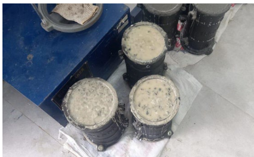
Gambar 8 : Proses perawatan beton uji
