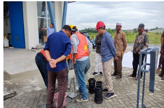
Gambar 6 : Pengujian Slump test
