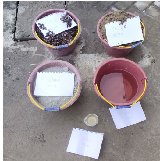
Gambar 5 : Material Cangkang sawit, pasir, air, dan semen yang sudah ditimbang
