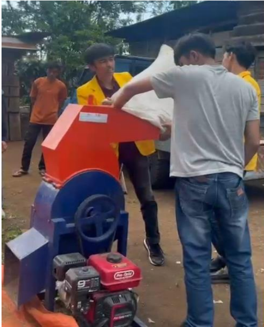
Gambar 4. Pencacahan kulit kopi menggunakan alat mesin tradisional.
