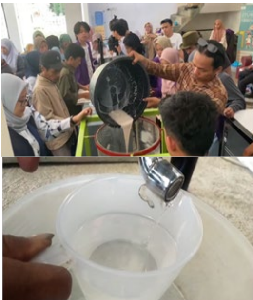
Gambar 2. Penerapan teknologi pemurnian Virgin Coconut Oil (VCO) berbasis sistem adsorpsi dan filtrasi. proses pemurnian dilakukan dengan metode penyaringan berlapis guna menghasilkan minyak kelapa murni berkualitas tinggi dengan kadar air rendah dan daya simpan yang lebih lama.
