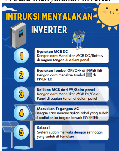
Gambar 8. Cara Menyetting Inverter
