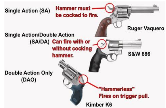
Gambar 3 Perbedaan Tampilan Revolver dengan Sistem Kerja Pelatuk SA, DA & DAO Sumber : Sapp, R. (2014).
