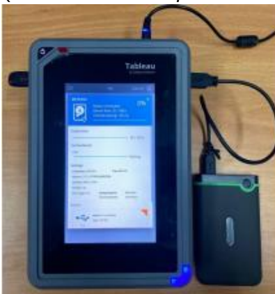
Gambar 1.2 Tableau Imager (Alat khusus untuk proses imaging harddisk dan flashdisk )
