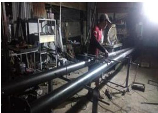
Gambar 3. Pembuatan Tiang Lampu
