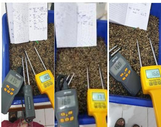
Gambar 2. Hasil kalibrasi kadar air kopi biji
