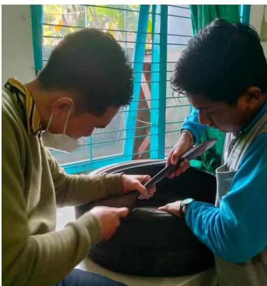
Gambar 2. Pemotongan Ban Bekas
