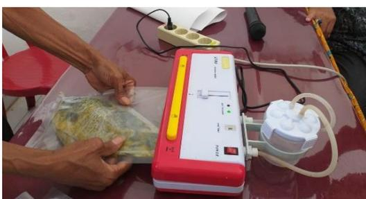
**Gambar 2. Proses Pengemasan Vakum menggunakan Alat Pengemas Vakum**
