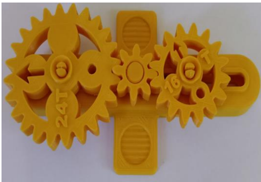
Gambar 9. Rangkaian roda gigi hasil cetak pada mesin 3D printing
