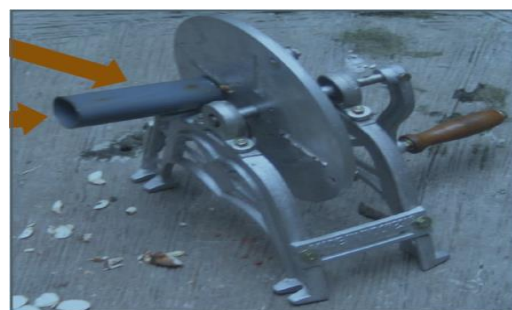
Gambar 4. Alat perajang keripik yang telah dimodifikasi
