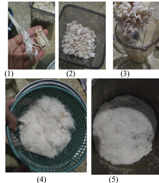
**Gambar 1.** Proses Memperoleh Ampas Tebu (1) pemisahan kulit tebu dari bagian berwarna hitam/keras (2). Ampas tebu dipotong-potong halus (3). Memasukkan ampas tebu ke dalam belender (4). Menyaring ampas tebu yang sudah diblender (5). Ampas tebu siap digunakan
