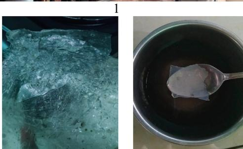
**Gambar 2.** Hasil Bioplastik Peserta (1). Hasil cetakan bioplastik sebelum dikeringkan; 2. Bioplastik yang sudah kering sempurna; 3.
