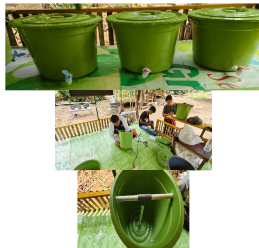
Gambar 2. Proses pembuatan teknologi komposter ember tumpuk.
