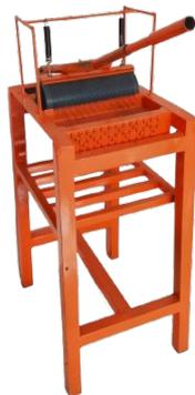
Gambar 9. Alat pemotong kerupuk
