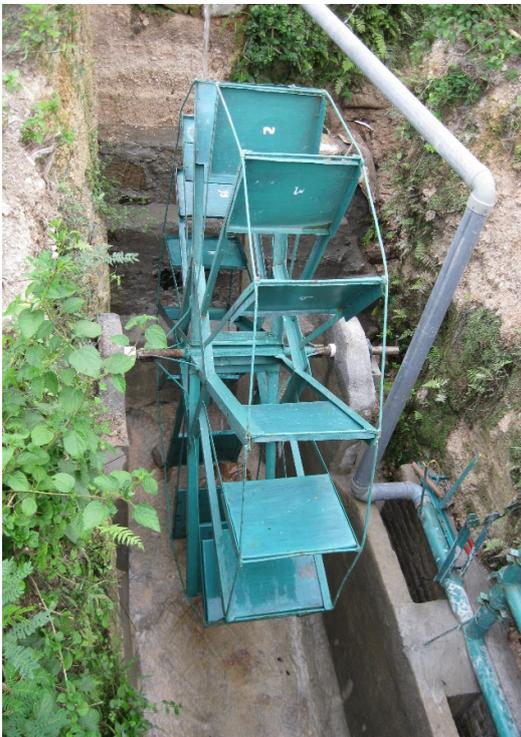
**Gambar 10. Pompa Air Berpenggerak Kincir Air Sudah Terpasang**
