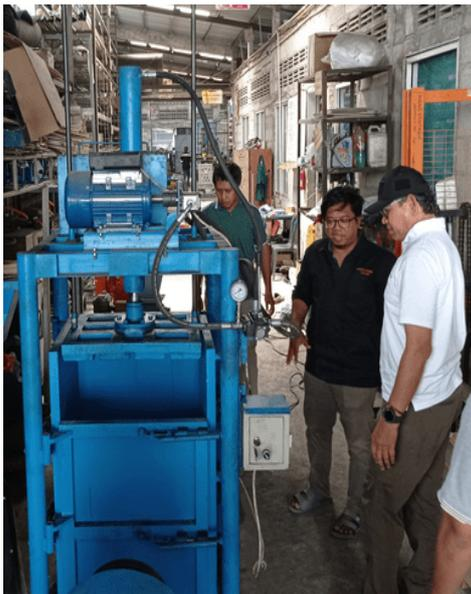
**Gambar 10:** Mesin press hidrolik untuk mengompres sampah menjadi bal padat
