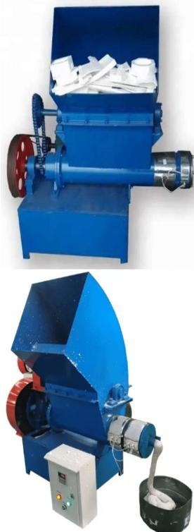
**Gambar 12:** Mesin plumer bahan plastik untuk mengatasi sampah residu
