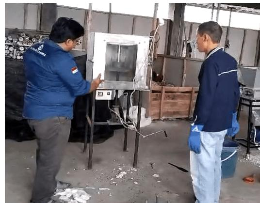
**Gambar 11:** Mesin *hot press* HDPE *recycle* dengan metode cetak kompresi
