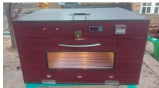
**Gambar 8. Alat Inkubator Mesin Penetas Telur hybrid yang sudah layak digunakan**
