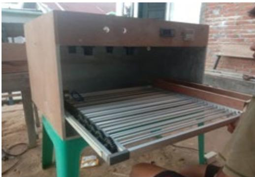
**Gambar 7. Pembuatan Alat Inkubator Mesin Penetas Telur hybrid dengan kapasitas 100 telur**
