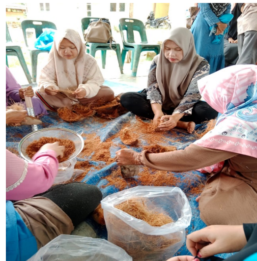
Gambar 2. Pengolahan limbah sabut kelapa menjadi cocopeat dan cocofiber.
