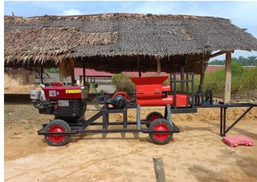
Gambar 5. Rakitan Mesin Cetak Batu Bata
