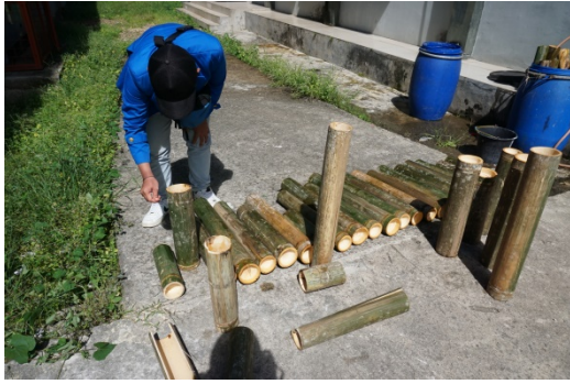
Gambar 1. Prosesn Mengeringkan Bambu yang Sudah Diawetkan (Foto. Arul Fikri, 2023)
