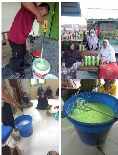
Gambar 7. Pembuatan secara mandiri oleh masyarakat desa Karang Anyar sabun cair pencuci tangan berbahan baku arang aktif dari limbah kulit singkong
