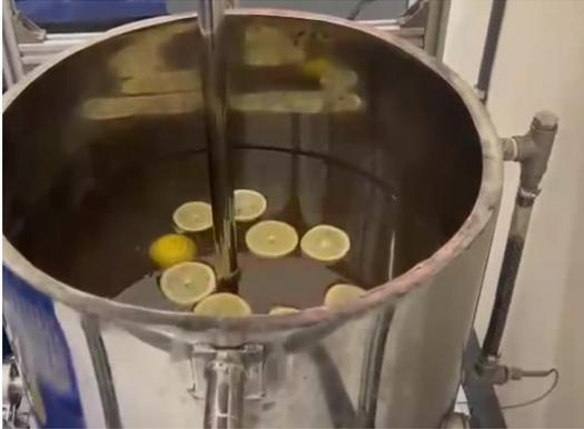
**Gambar 3:** Sistem pemanas menggunakan HTF yang dialirkan pada dua sisi bejana melalui fluida minyak
