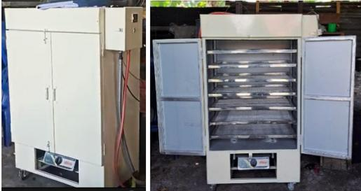
**Gambar 5.** Alat pengering sistem hybrid dengan sumber energi panas LPG dan Listrik.
