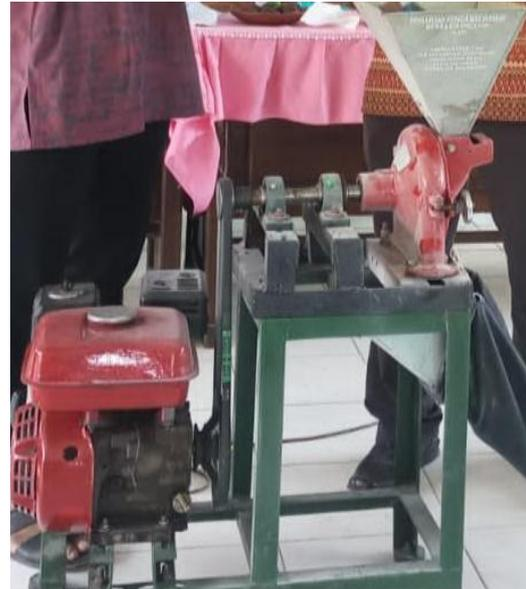
**Gambar 7. Mesin penggiling kerang hijau**
